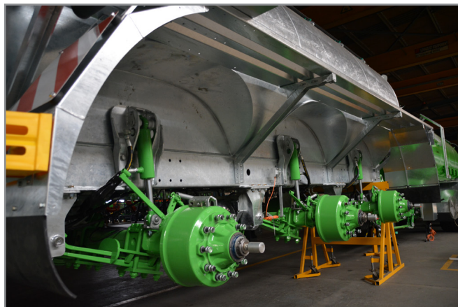
Volumetra 22500 с пазами для больших колес и ходовой Hydro-Tandem
